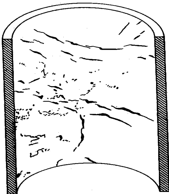
Figura 10-9 Rachaduras por tratamento térmico em parede de cilindro.
