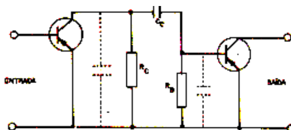
Figura 8-6 Capacitância entre os elementos do transistor
