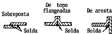
Figura 6-21 Soldagem de juntas com prata.
