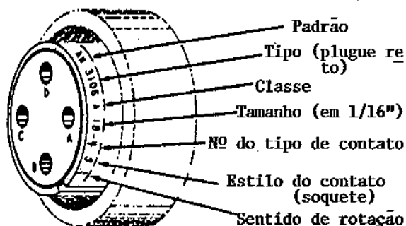
Figura 4-119 Codificação do conector AN.
